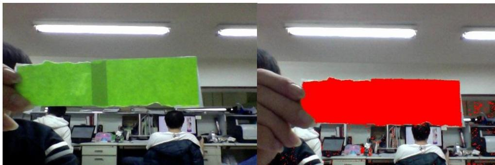
3. 在大致得知影像的位置我們再進一步使用 remove small object 將辨識錯誤的小物體濾掉。
