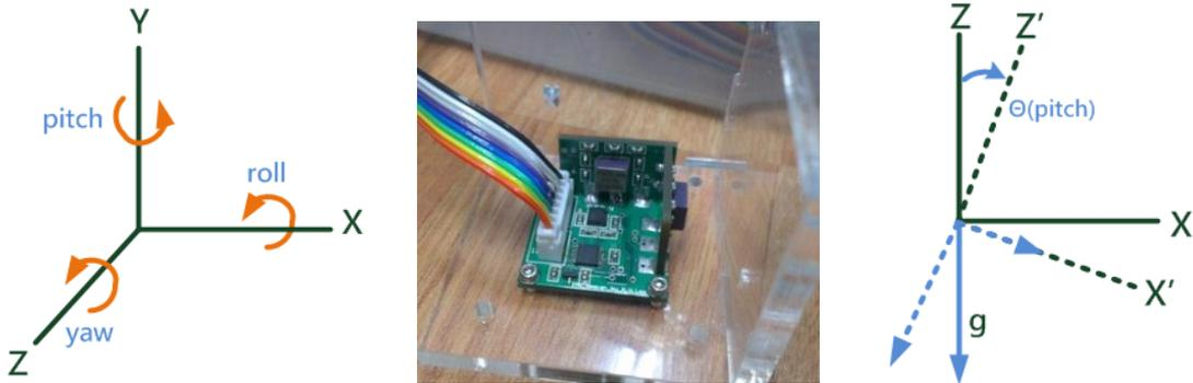
三軸陀螺儀可量測 roll、pitch、yaw 的角速度資訊，藉由積分我們可以得知機器人座標相對於世界座標的角度，但由於我們並不曉得在某一時刻 IMU 是先對 Z 軸旋轉還是先對 Y 軸旋轉，我們只知道在某一時刻的三軸角速度為多少，在無法使用 X-Y-Z fixed angle 旋轉矩陣來積分下，我們使用四元數法(quaternion)達到積分的目的。
